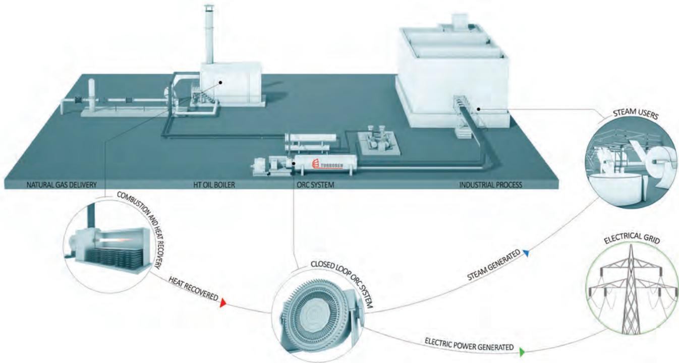
Steam&Power offre infatti la possibilità di integrare o sostituire completamente il gas naturale con combustibili alternativi:
